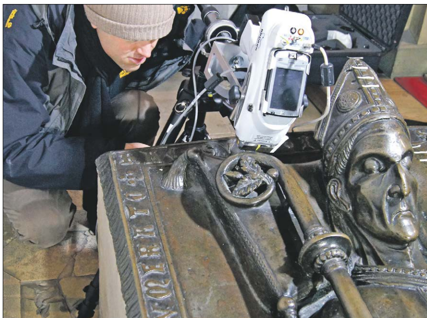
▲ Diplom-Ingenieur Björn Seewald vom Bayerischen Landesamt für Denkmalpflege nimmt an dem Grabmal eine Röntgenfluoreszenzanalyse vor.
