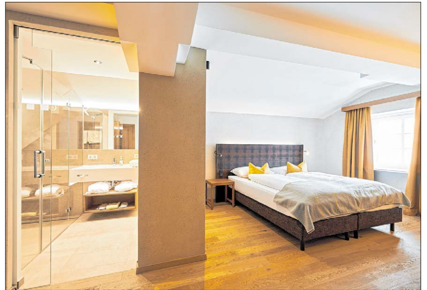
▲ Tonputz wirkt feuchteregulierend und verhindert Schimmelbildung. Gerüche werden absorbiert und durch die antistatische Oberfläche die Staubbildung in Innenräumen deutlich reduziert. Foto: Emoton/Hotel Après Post“
