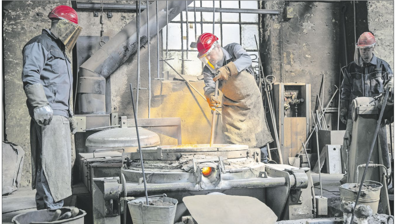
▲ Arbeiter mit Helm und Gesichtsschutz arbeiten bei der Produktion einer Glocke am Schmelzofen.
