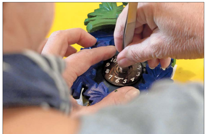
▲ Zum Schluss werden das Zifferblatt auf die Vorderseite geklebt und die beiden Zeiger für die Stunden und für die Minuten eingesetzt.
