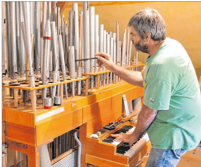
▲ Beim Orgelbau ist noch echtes Handwerk und Können gefragt: Achim Schneider (Bild links) erwärmt mit einem kleinen Bügeleisen aufgeklebtes Leder, damit es sich für ein winziges Scharnier einer Drehorgel mit Leim und Holz verbindet. Wolfram Stütze (Bild rechts) prüft den Klang der Orgelpfeifen. Fotos: Traub
