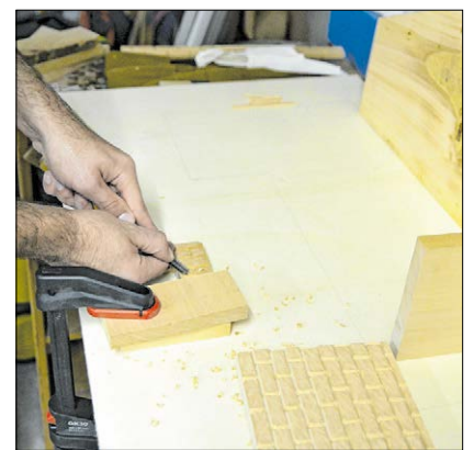
▲ Mit Hilfe der Kerbschnitttechnik werden Mauersteine imitiert.
