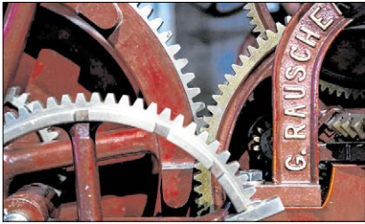
▲ Blick in das ausgefeilte Zahnradwerk einer Turmuhr von Rauscher. Foto: oh
