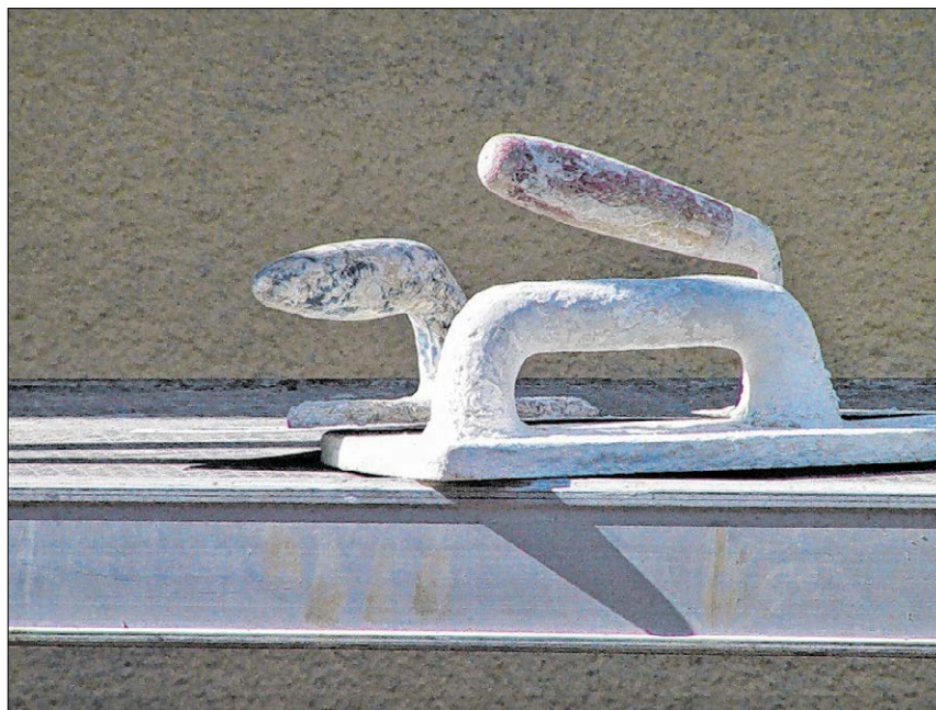
▲ Mit unterschiedlichen Spachteln wird die Gipsmasse ins Bohrloch gedrückt und dann verstrichen. Foto: Rainer Sturm/pixelio.de
