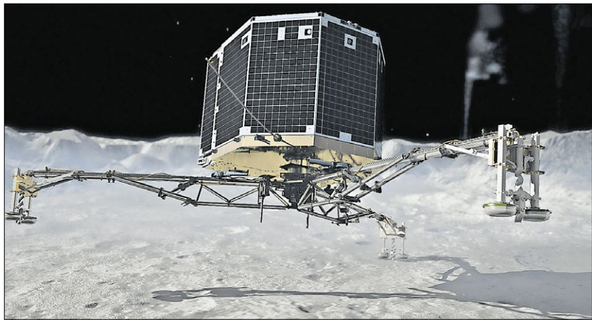
▲ Die Landung von Philae auf dem Kometen Tschurjumow-Gerassimenko. Die Verankerung durch die Harpunen im Eis missglückte jedoch.
