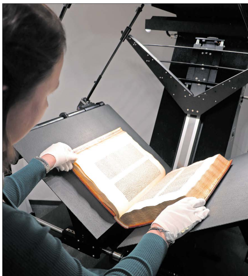
▲ Vorsichtig platziert eine Mitarbeiterin die fast 600 Jahre alte Gutenberg-Bibel in dem speziellen Buchscanner, der bei der Digitalisierung zum Einsatz kommt.
