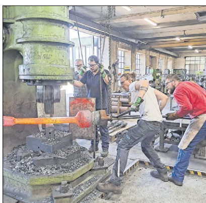
▲ Glühend rot: Die Hammerschmiede beim Bearbeiten eines Klöppels.
