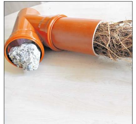
▲ Probleme durch Betonbrocken im Kanal und Wurzeln, die an Schadstellen einwachsen, werden von den Spezialisten fachgerecht gelöst. Foto: Bunk
