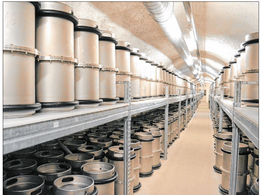
▲ Kein Bierkeller: Der Barbarastollen enthält 1500 solcher Fässer aus Edelstahl. Eine Milliarde mikroverfilmte Dokumente der deutschen Geschichte sind darin verwahrt.
