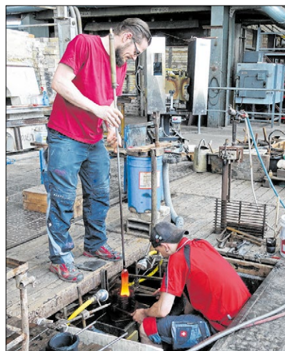
▲ Das glühend-heiße Glas wird im Wasserbad abgekühlt.
