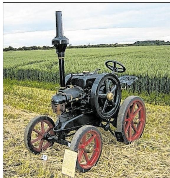
◀ Ein Lanz HL, Baujahr 1921: Der Name „Bulldog“ leitet sich aus der gedrungenen Form sowie dem Glühkopf ab, der einer Hundeschwanz ähnelt. Er erreichte eine Dauerleistung von 12 PS und wurde in verschiedenen Ausführungen gefertigt. Das Kürzel „HL“ steht für „Huber/Lanz“ und würdigt damit auch den Konstrukteur, Fritz Huber.
