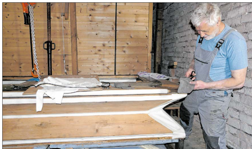
▲ Bevor das Instrument wieder erklingen konnte, war Orgelbauer Hermann Weber im Turm der Wallfahrtskirche damit beschäftigt, den Blasebalg zu reparieren. Dazu verwandte er Schafsfleder und Pergamentstreifen.
