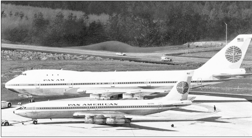
▲ Unübersehbarer Größenunterschied: Hinter dem Vorgängermodell, einer Boeing 707-321B von Pan Am, zeigt sich die Dimension der Boeing 747. Foto: imago
