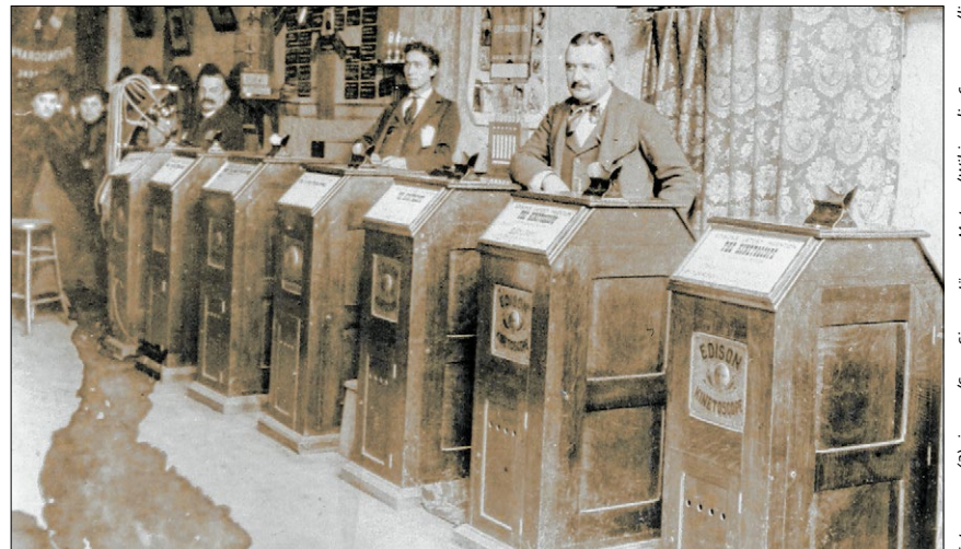
▲ Ein Kinetoskop in San Francisco: In den Schaukästen transportierte ein Elektromotor 40 Einzelbilder pro Sekunde an einem Guckloch vorbei. Durch eine in Gegenrichtung rotierende Schlitzblende schienen sich die Bilder zu bewegen.
